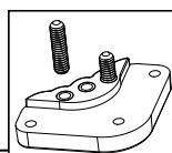
Estos niveladores exclusivos se alinean de forma automática para una instalación fácil. Utilice la lengüeta curva de los niveladores de la placa de accesorio para ubicar cada nivelador en la esquina de la abertura de la placa de accesorio y apriételos en su lugar con los tres tornillos de rosca de ángulo grande de 1 1/4" por nivelador. Tenga cuidado de no apretar demasiado.
