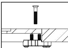
Si está utilizando la placa de accesorio de la mesa para rebajadora Precision Kreg, atomille los cuatro tornillos para metales de cabeza plana Phillips (tornillos para fijación) de 1/4-20 x 1 3/4" a través de los orificios avellanados en el orificio central de cada nivelador y presione. Vuelva a deslizar el dedo a lo largo del perímetro de la placa de accesorio para verificar que todos los lados de la placa de accesorio estén alineados con la superficie de la mesa para rebajadora.
