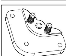
El diseño exclusivo de los niveladores de placa de accesorio Precision y el sistema de tornillo de nivelación ajustable ejerce presión en ambos lados de la placa de accesorio, de manera que, una vez que se fija en su posición, la placa de accesorio permanece al ras sin importar el peso que se aplique. Los 8 tornillos de nivelación y los 4 tornillos para fijación trabajan juntos para mantener la placa de accesorio al ras con la superficie de la mesa para rebajadora en todo momento.
