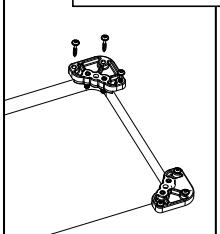
Atomille los ocho tornillos de fijación con cabeza hueca de 1/4-20 x 1 1/2" en los dos orificios, como se muestra, y atomille hasta aproximadamente la mitad.
