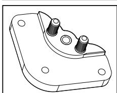
La conception unique des patins réglables de la plaque d'insertion de précision et le système de vis de mise à niveau ajustables permettent d'exercer une pression de part et d'autre de la plaque d'insertion, de sorte qu'une fois installée, cette dernière demeure en place, peu importe le poids soutenu. Grâce aux huit vis de réglage et aux quatre vis de verrouillage, la plaque d'insertion reste de niveau avec la surface de la table à toupie en tout temps.
