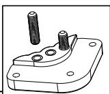
Ces patins réglables uniques s'alignent d'eux-mêmes, ce qui facilite l'installation. Utilisez la languette incurvée des patins réglables de la plaque d'insertion pour positionner chaque patin réglable dans l'un des coins de l'ouverture de la plaque d'insertion, et fixez chacun à l'aide de trois vis à filage normal de 1 1/4 po. Prenez soin de ne pas serrer excessivement.
