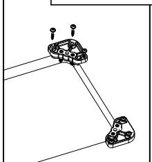
Enfilez les vis de calage à tête creuse à bout cuvette de 1/4 po – 20 UNC x 1 1/2 po dans les deux trous illustrés, et vissez jusqu'à mi-course.
